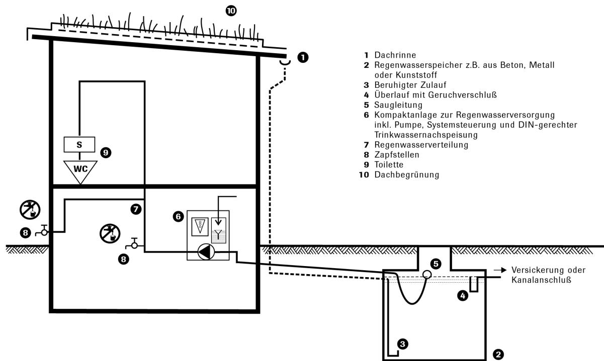
**Regenwassernutzung und Dachbegrünung sind technisch ausgereifte Bausysteme. Ihre Kombination bietet technische Vorteile und wirkt sich positiv auf die Umwelt aus. Regenwassernutzungsanlagen sparen Trinkwasser und tragen somit zur Schonung der Wasser-Ressourcen bei. Begrünte Dächer verbessern das Mikroklima, schützen die Dachabdichtung und leisten einen wesentlichen Beitrag zur Regenrückhaltung.**
